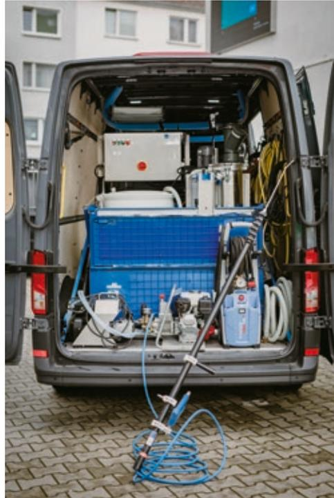
**Im Transporter befinden sich neben der Wasseraufbereitung rund 400 Meter Wasserschläuche.**
