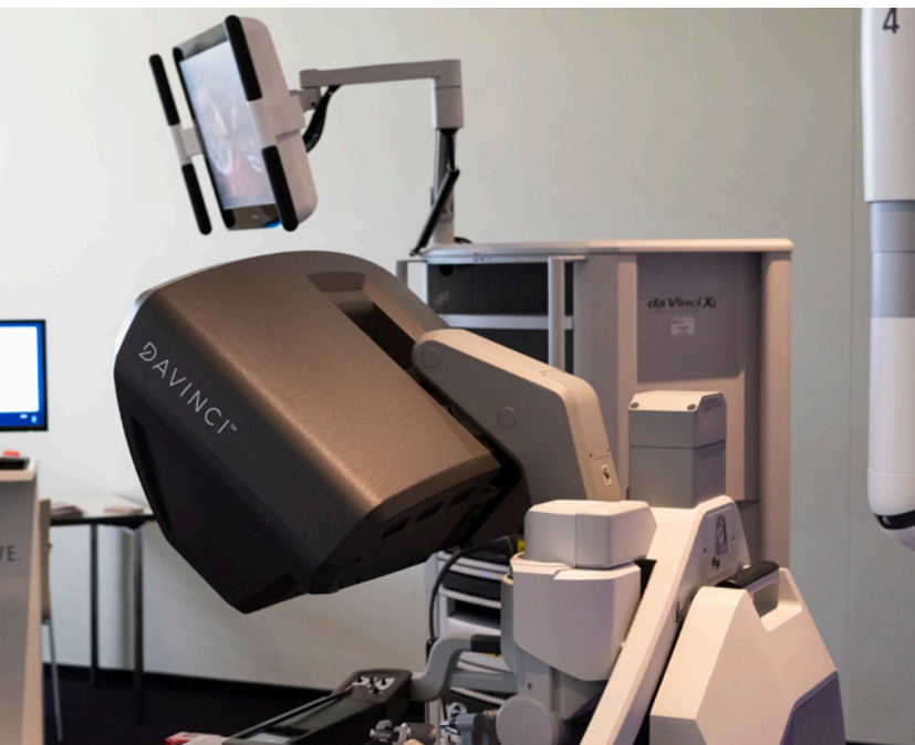
Mit diesem Modul steuern die Ärzte den Roboter
